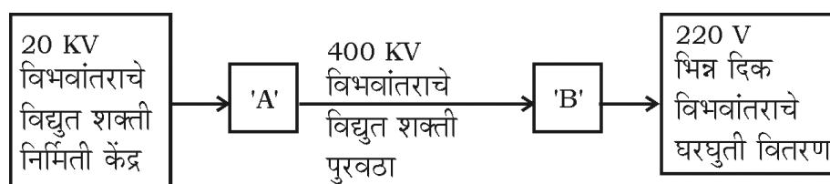
A आणि B ही ठिकाणे दर्शविलेल्या स्थानावर वापरलेल्या उपकरणांची नांवे लिहा.
